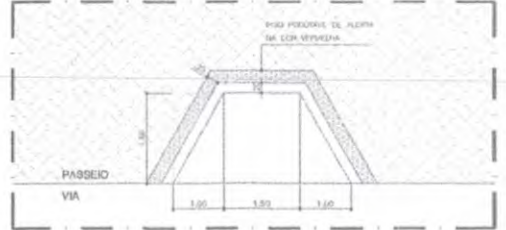
16.01 DETALHE - ACESSIBILIDADE ESCALA 1:20
