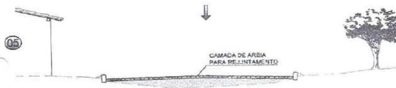
ANTES DA COMPRESSÃO COM O ROLO METÁLICO, JOGA-SE AREIA SOBRE O CALÇAMENTO, NA QUANTIDADE SUFICIENTE PARA PREENCHER AS JUNTAS E FORMAR UMA CAMADA SOBRE O CALÇAMENTO DE APROXIMADAMENTE 2CM.
